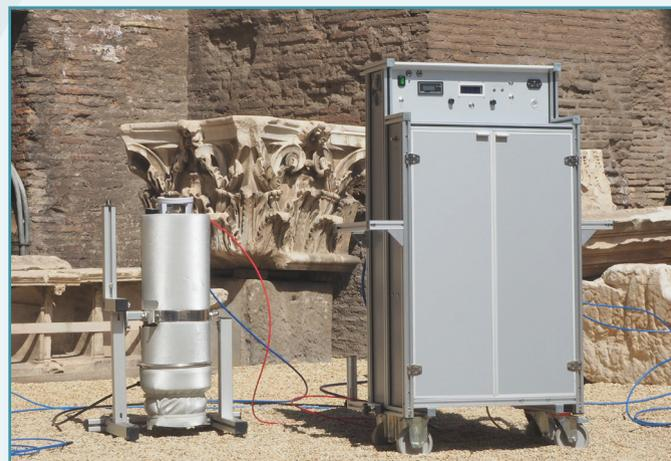
Hydra R.O.1 CO<sub>2</sub> è una strumentazione portatile ideata e realizzata per essere **facilmente trasportabile ed adattabile alle esigenze di cantiere e di laboratorio**. L'impianto è costituito da un telaio in alluminio anodizzato rivestito da pannelli in materiale leggero e resistente. Hydra R.O.1 CO<sub>2</sub> è in possesso della **Dichiarazione di Conformità UE**.
